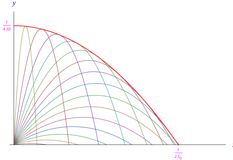
Figura 2: Parabola di sicurezza quale curva inviluppo della famiglia di curve piane (1).
