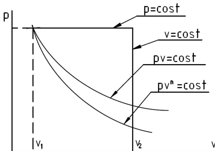
Un fluido si dilata da  $0,95 \text{ m}^3$  a  $2,2 \text{ m}^3$  sotto la pressione costante di  $9 \text{ bar}$ .
