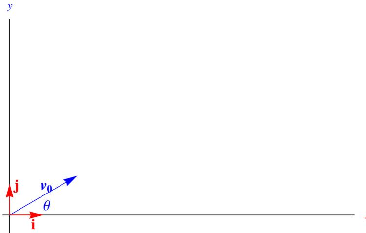
Figura 1: Sistema di riferimento inerziale per lo studio del moto di un proiettile in un mezzo viscoso.
