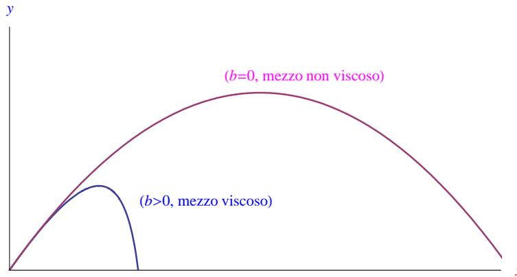
Figura 3: La curva in blue è la traiettoria per  $b > 0$ , mentre l'altra curva corrisponde al caso ideale di assenza di viscosità. Notiamo che nel caso non ideale la gittata è minore, e il proiettile va in caduta verticale. La costante di tempo è  $\tau = 4 \cdot 10^{-2}$  s.
