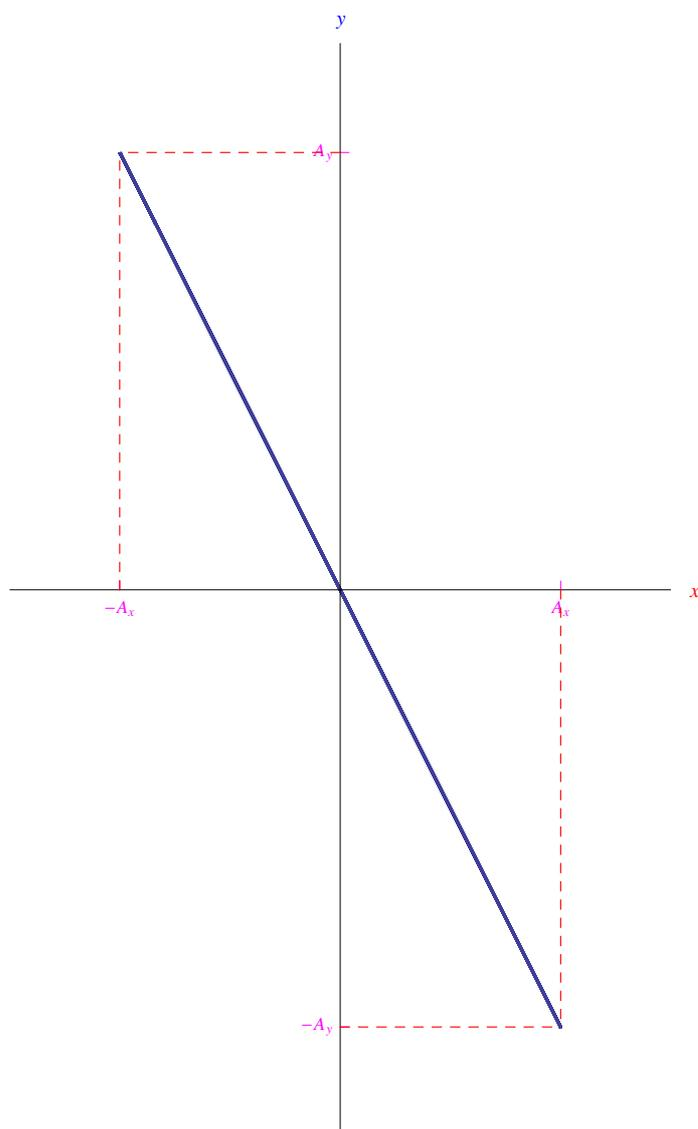
Figura 3: Se i moti armonici componenti sono in opposizione di fase, la traiettoria del moto risultante è il segmento di retta di equazione  $y = -\frac{A_y}{A_x}x$  e di estremi  $(-A_x, A_y)$ ,  $(A_x, -A_y)$ .
