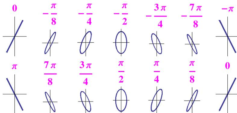
Figura 4: Se i moti armonici componenti sono in opposizione di fase, la traiettoria del moto risultante è il segmento di retta di equazione  $y = -\frac{A_y}{A_x}x$  e di estremi  $(-A_x, A_y), (A_x, -A_y)$ .
